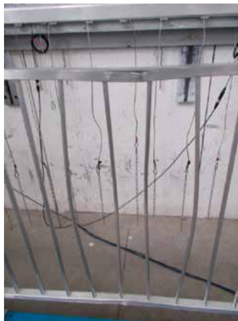
Particolare del campione dopo l'urto
