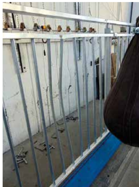
Fotografia del campione dopo l'urto al centro del tamponamento.
