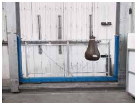
Fotografia del campione dopo l'urto al centro del tamponamento.
