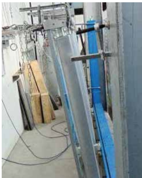
Fotografia del campione sottoposto a carico statico lineare orizzontale.
