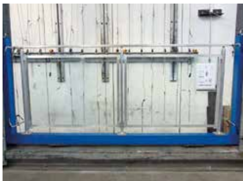
Fotografia del campione sottoposto a carico statico lineare orizzontale.
