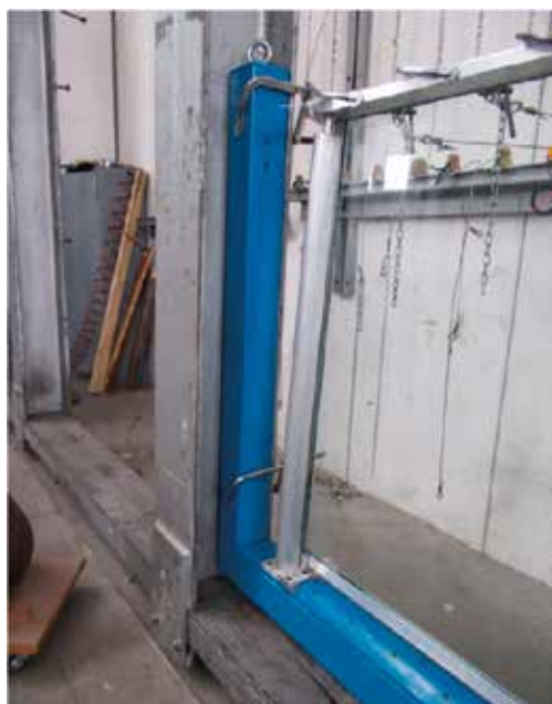
Fotografia del campione sottoposto a carico statico lineare orizzontale.
