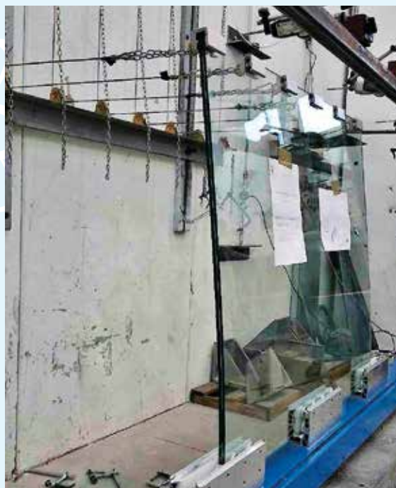
Fotografia del campione durante l'applicazione del carico statico lineare orizzontale.
