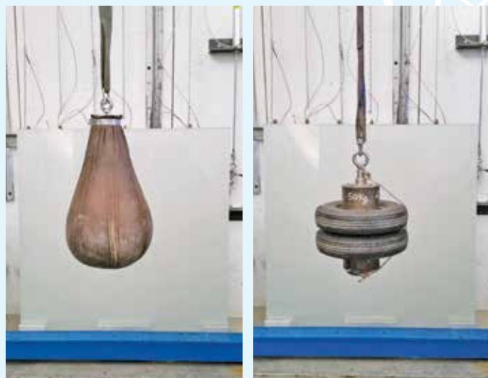
Fotografie del campione dopo urto al centro del tamponamento.
