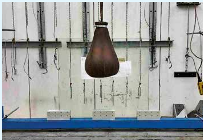
Fotografia del campione dopo urto al centro del tamponamento.
