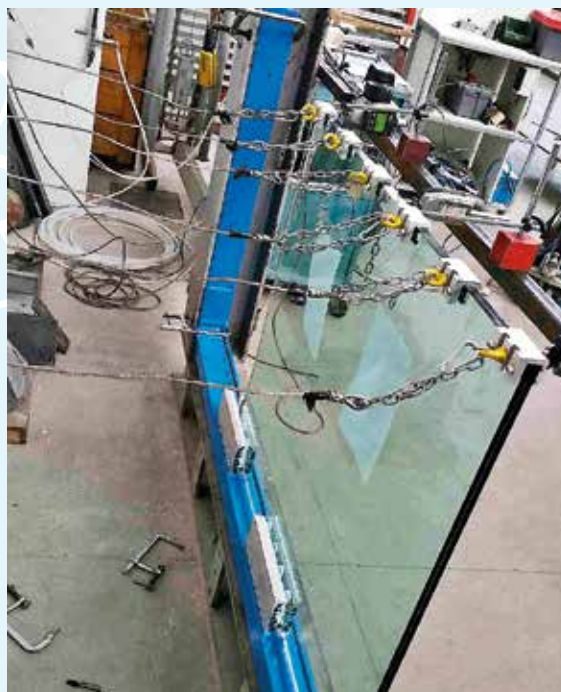
Fotografia del campione dopo essere stato sottoposto al carico statico lineare orizzontale.
