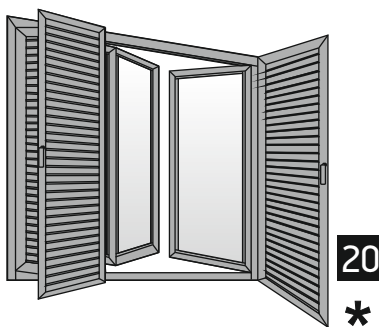
Τρίφυλλο ανοιγόμενο - ανακλινόμενο παράθυρο με παντζούρι Three sash tilt & casement window with shutter
